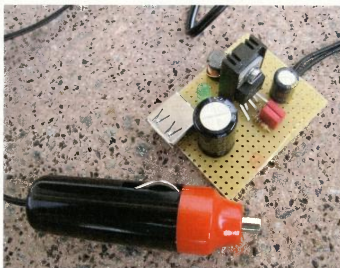
Obr. 2. Hotová dobíjačka pred montážou do krabičky
