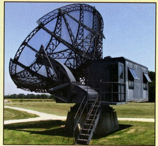
Obr. 2. Radar Würzburg Riese s parabolou o průměru 7,4 m a s pracovní frekvencí 560 MHz
