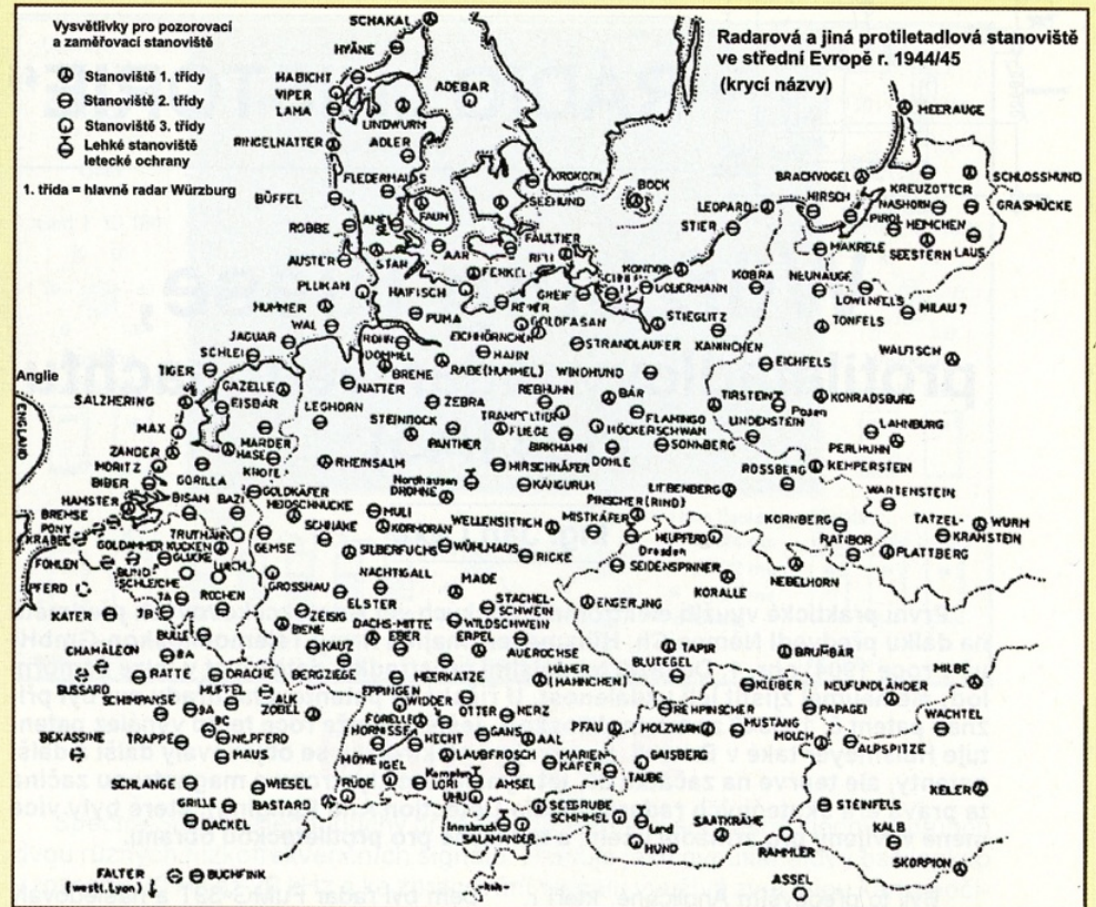
Obr. 4. Mapa rozprostření protiletadlové obrany v Evropě. Stanoviště 1. třídy = radary 1x Jagdschloss, 1x Wassermann, 2x Freya, 1 – 2x W. Riese. Stanoviště 2. třídy = 1 – 2x Freya, 2x W. Riese. Stanoviště 3. třídy = 2x Freya, 1x W. Riese
