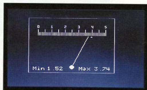
Obr. 5. Zobrazení virtuálního měřidla s pravidelně překreslovanou ručkou
