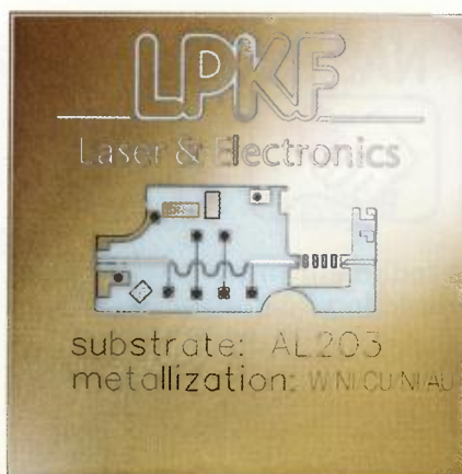
Obr. 6. Plošný spoj na pozlaceném substrátu \text{Al}_2\text{O}_3 , vyrobeno na LPKF ProtoMat D104
